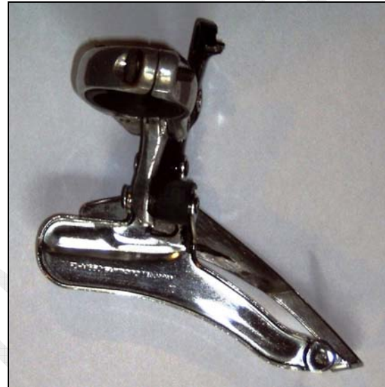
Schaltwerk nach einer Reinigung mit EM-A
