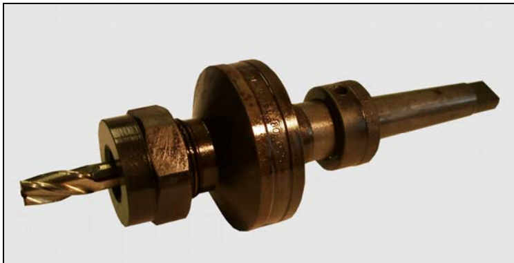
Nach der EM-A Reinigung müssen Werkzeuge neu eingefettet werden
