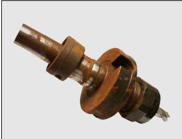
Fräskopf mit deutlichen Rost und Schmutzanlagerung
